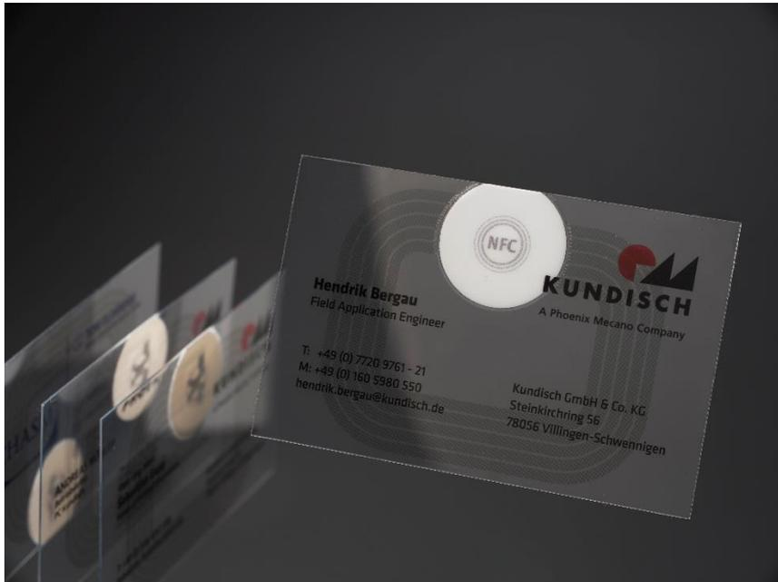
*Abb. 5: Transparente NFC-Tags. Die hohe Leitfähigkeit bei gleichzeitig hoher Transparenz ermöglicht die Herstellung transparenter NFC-Tags. Die Frequenz von 13,56 MHz wird erreicht, obwohl der Spulenwiderstand deutlich höher ist als bei Aluminium-geätzten Antennen. Transparente NFC-Tags können mit gedruckten NFC-Tags, die Silber- oder Kupfertinten verwenden, vergleichbar sein, sofern das Design die neuartigen Materialparameter von CNT + Metal Mesh berücksichtigt.*
